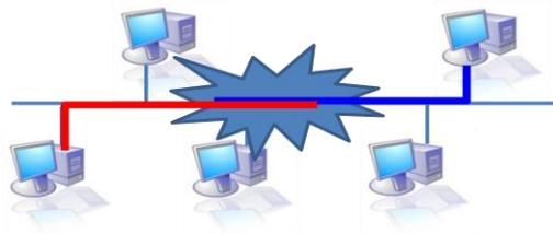
Figure 4.10. Collision des trames
