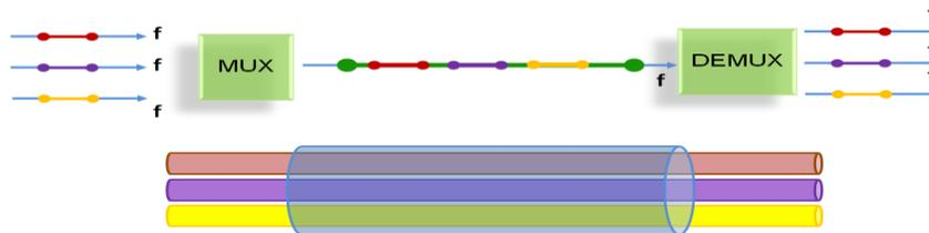
Figure 3.16. Principe de multiplexage fréquentiel
